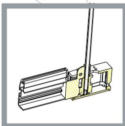
sul radiocomando, il sistema si abbassa liberando la camme e risale invertendo automaticamente il senso della manovra.
